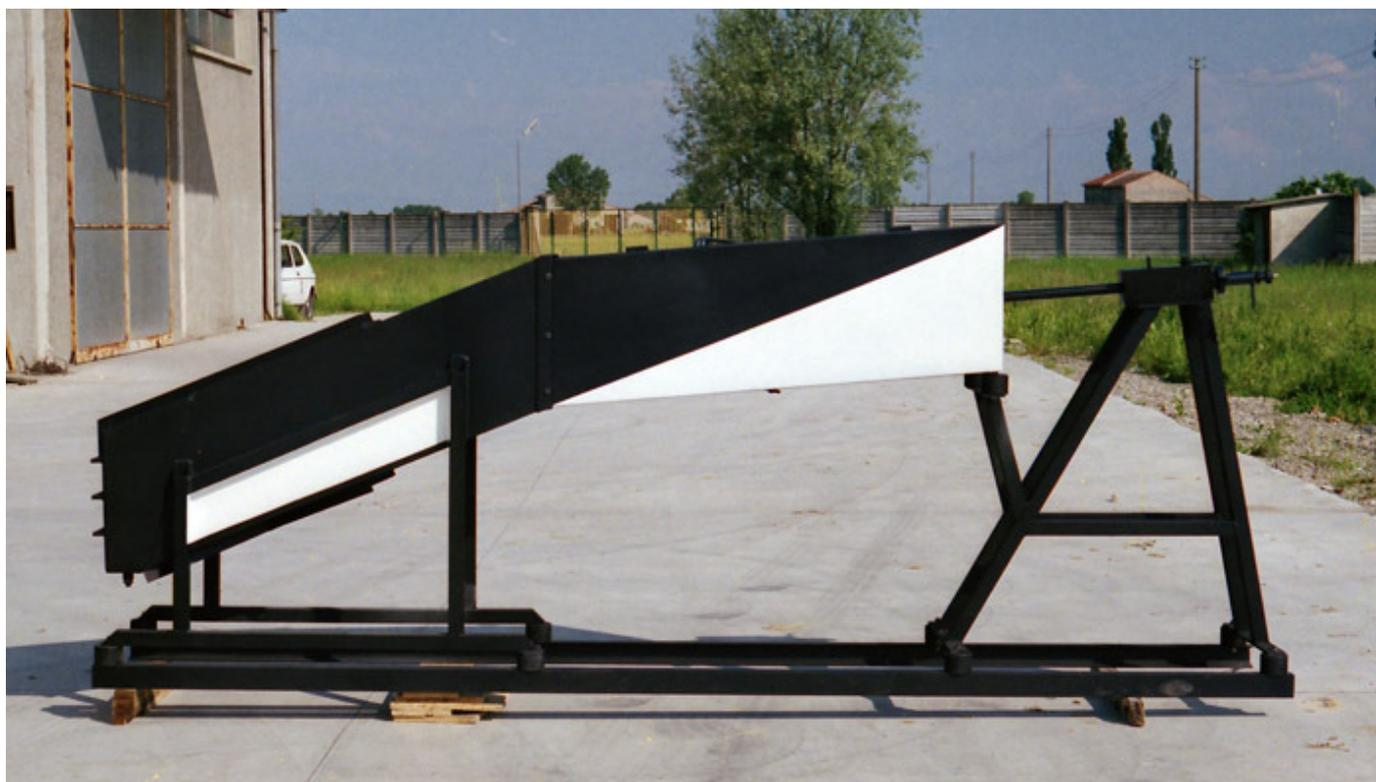
Permette di effettuare misure relative a tempo di canna, velocità alla bocca ( e misure derivate quali elergia etc) e misure di balistica interna
