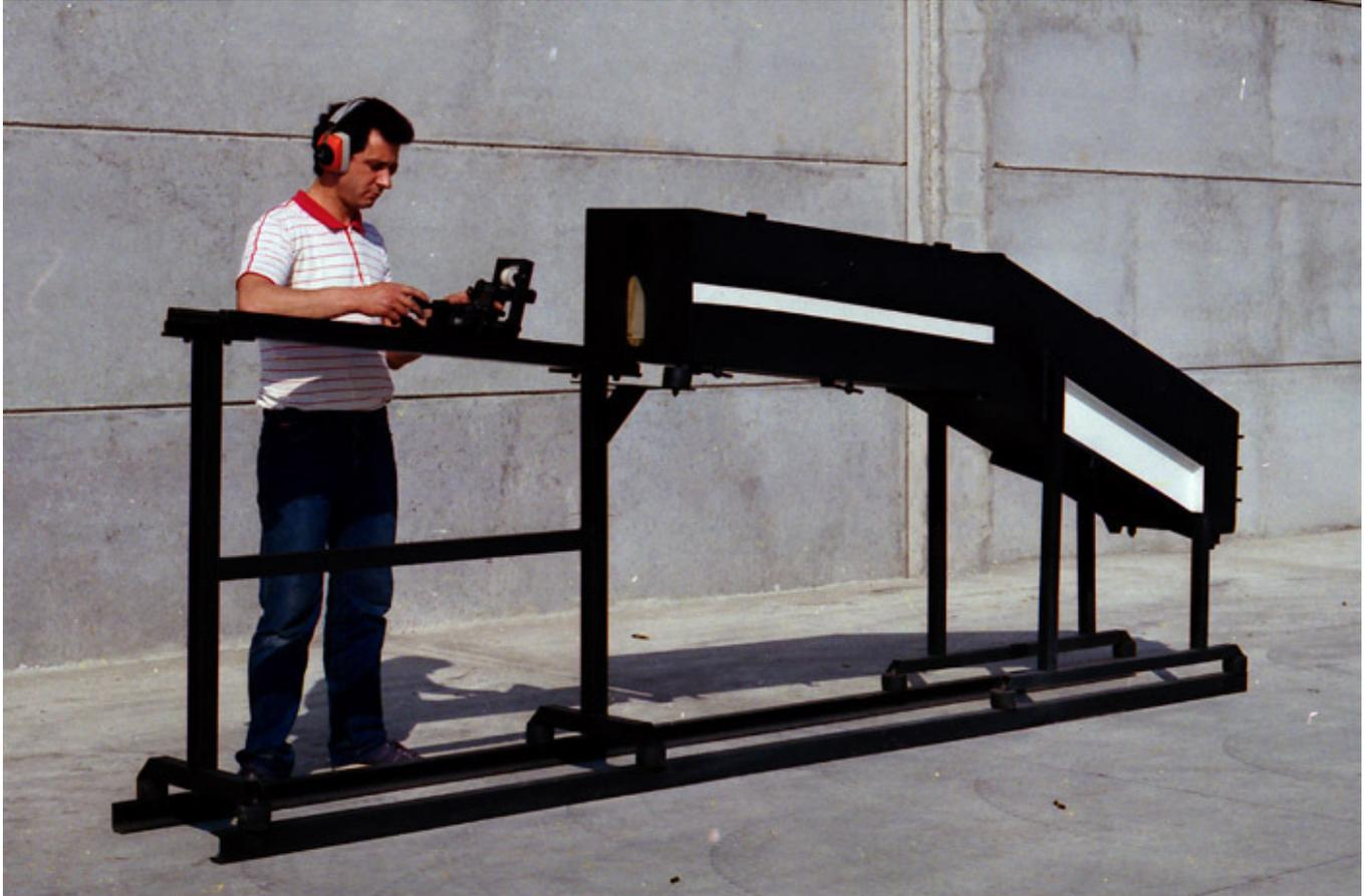
Permette di effettuare misure di velocità e funzionalità dell'arma. Utilizzando gli appositi sostegni possono essere effettuate anche prove di penetrazione su vetri antiproiettile protezioni balistiche o gelatine balistiche.
